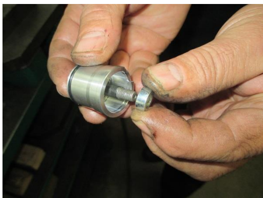
Vkládáme rozpěrnou trubku, šroub je tam pouze pro vystředění rozpěrky.
