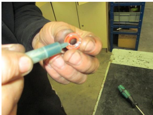
Dáváme gufero, které před vložením namažeme tukem.
