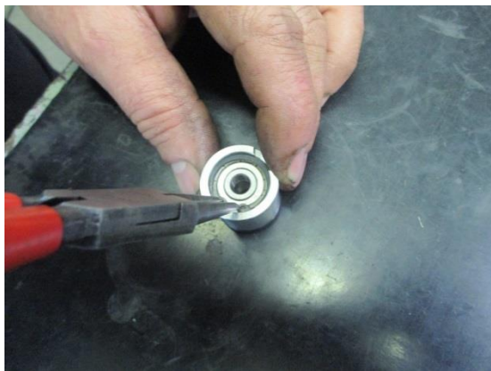
Ložisko zajistíme pojistným kroužkem.
