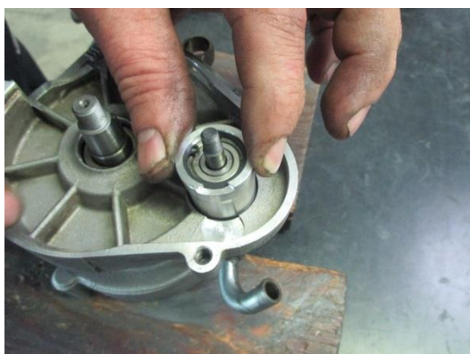
Adaptér vkládáme do bloku motoru
