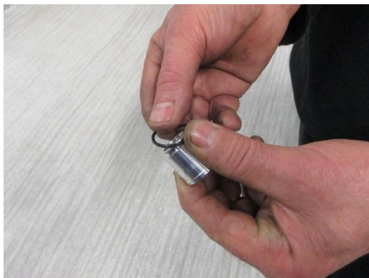
Na adaptér nasadíme těsnící o-kroužek
